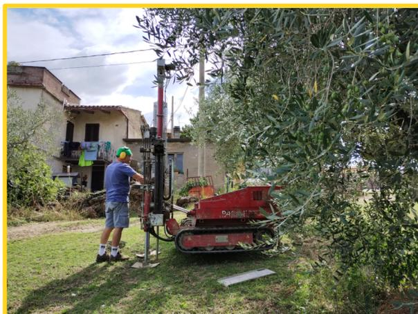
Punto prova Penetrometrica dinamica DPSH
