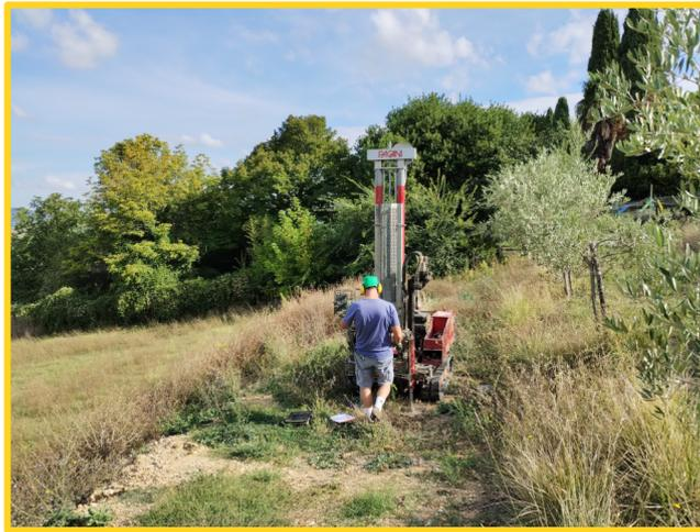
Punto prova Penetrometrica dinamica DPSH
