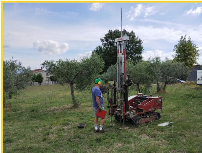
Punto prova Penetrometrica dinamica DPSH
